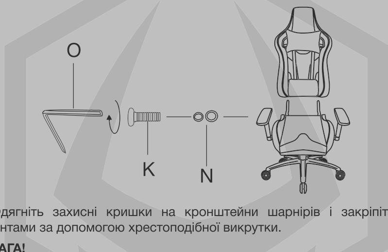
7. Одягніть захисні кришки на кронштейни шарнірів і закріпіть їх ґвинтами за допомогою хрестоподібної викрутки.
